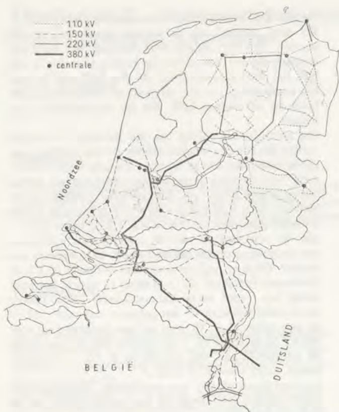
afb. 4 - Het bestaande hoogspanningsnet in Nederland, alsmede de netten waarvoor het besluit om te bouwen is genomen.
