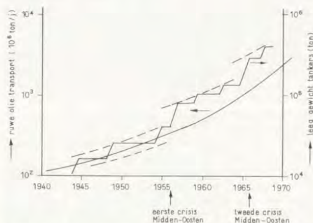
Fig. 3. De ontwikkeling van het ruwe olietransport en de grootte van de tankers [36].
