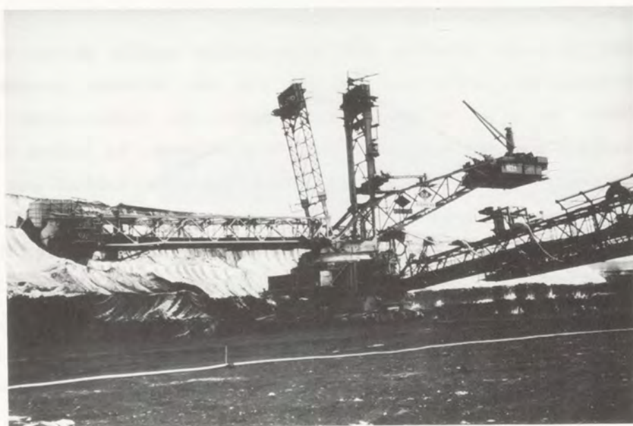
Figuur 4. Graafwielbagger in de bruinkoolwinning bezig met verwijdering van de deklaag.
