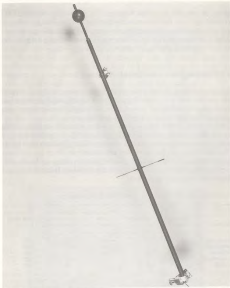
Afb. 3.4 Met koolstofvezel versterkte composietantenne voor de Venus-Halley missie.
