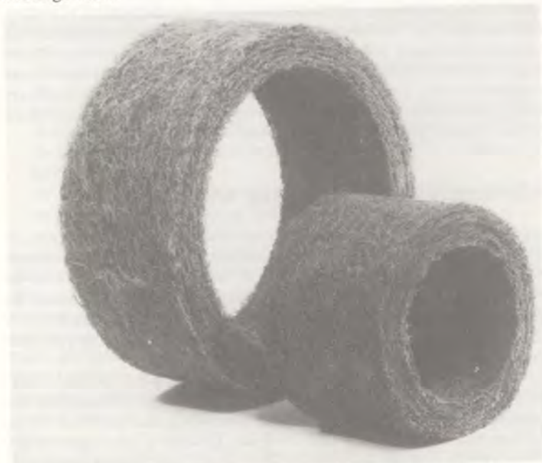
Afb. 3.10 Filter van Cocolok (plantaardige vezels met rubberlatex).
