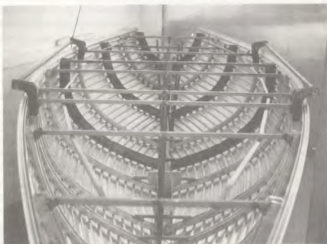
Afb. 3.8 Boot met aluminiumprofielen, in aanbouw.
