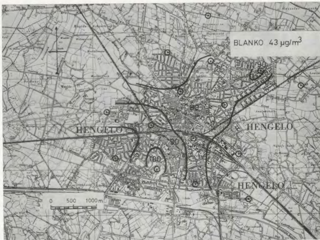
Fig. 6. Hengelo, iso-concentratielijnen voor 50%-overschrijdingswaarden in \mu\text{g}/\text{m}^3 \text{SO}_2 , winter 1968-69.
