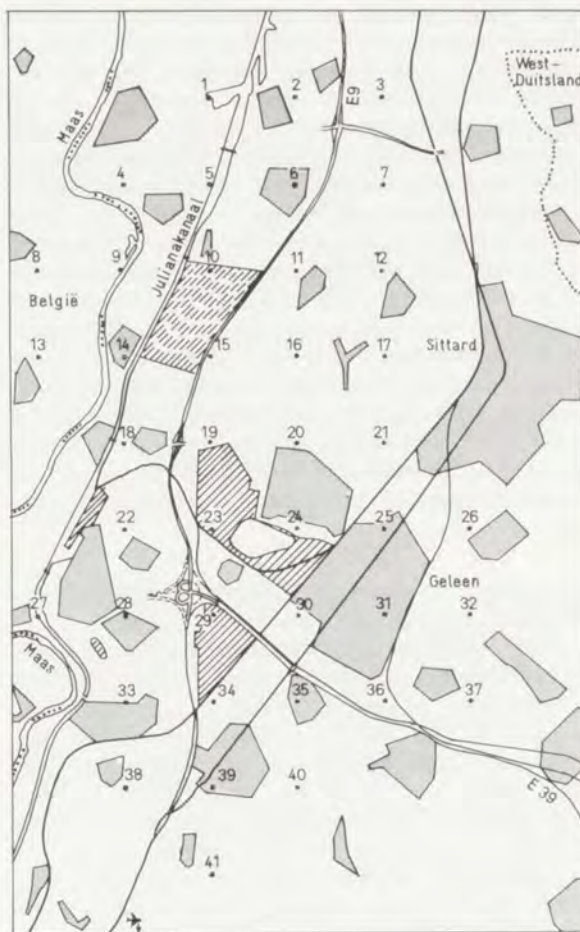
Fig. 3. Meetpunten voor zwaveldioxyde en stikstofoxyden.
