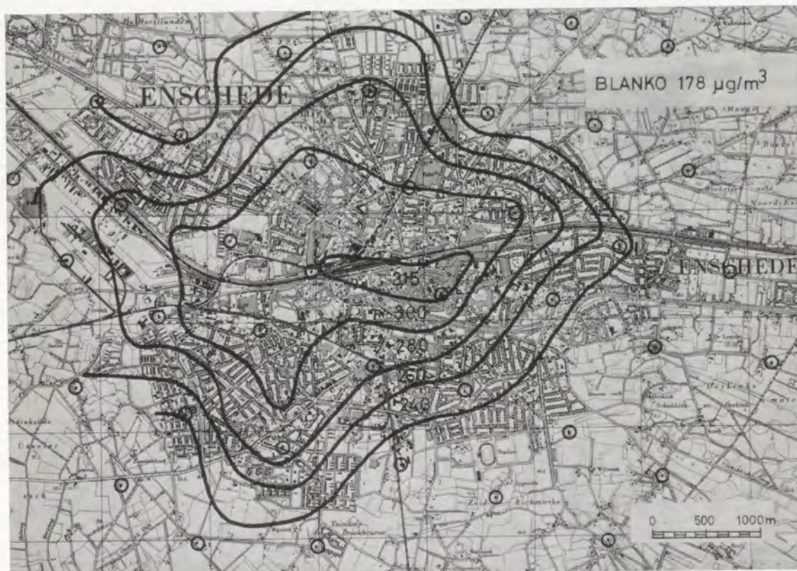
Fig. 2. Enschede, iso-concentratielijnen voor 2%-overschrijdingswaarden in \mu\text{g}/\text{m}^3 SO 2 , winter 1968-69.
