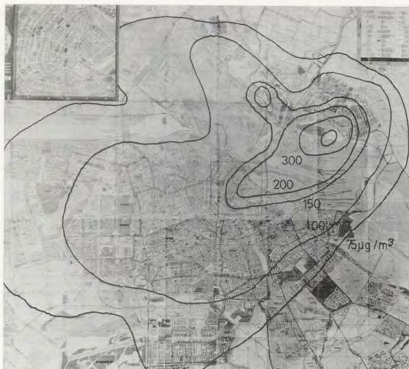
Fig. 12. Amsterdam, iso-concentratielijnen voor 2%-overschrijdingswaarden in \mu\text{g}/\text{m}^3 \text{SO}_2 , zomer 1970.
