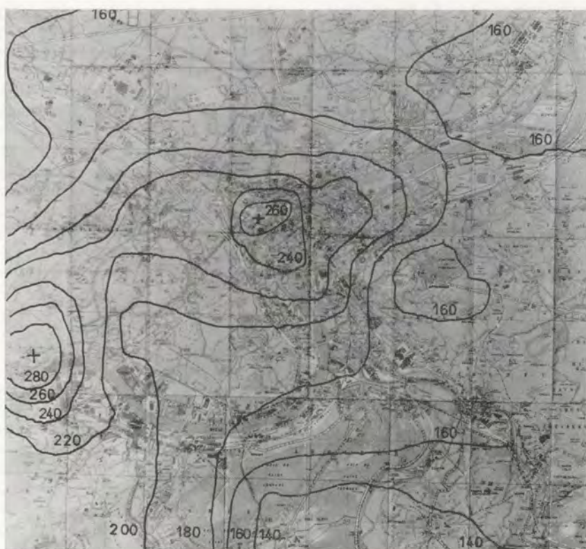
Fig. 15. Luik, iso-concentratielijnen voor gemiddelde \text{SO}_2 -dagwaarden in \mu\text{g}/\text{m}^3 voor winter 1968-69.
