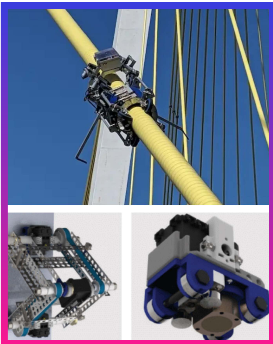
Figuur 5: Inspectie door een "robot-gekko".
