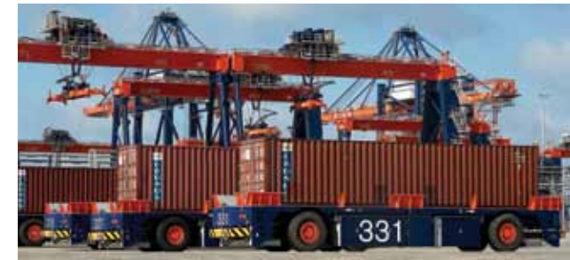
Figuur 8.4 Automated guided vehicles op het ECT terrein Euromax. Foto: ECT.
