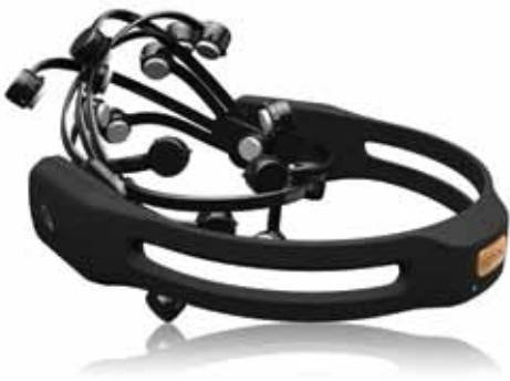
Figuur 4.5 De Emotiv EPOC neuro headset maakt gebruik van sensoren om af te stemmen op elektrische signalen die de hersenen op natuurlijke wijze produceren. De headset neemt zo gedachten, gevoelens en uitdrukking van een gebruiker waar. Foto: Emotiv.
