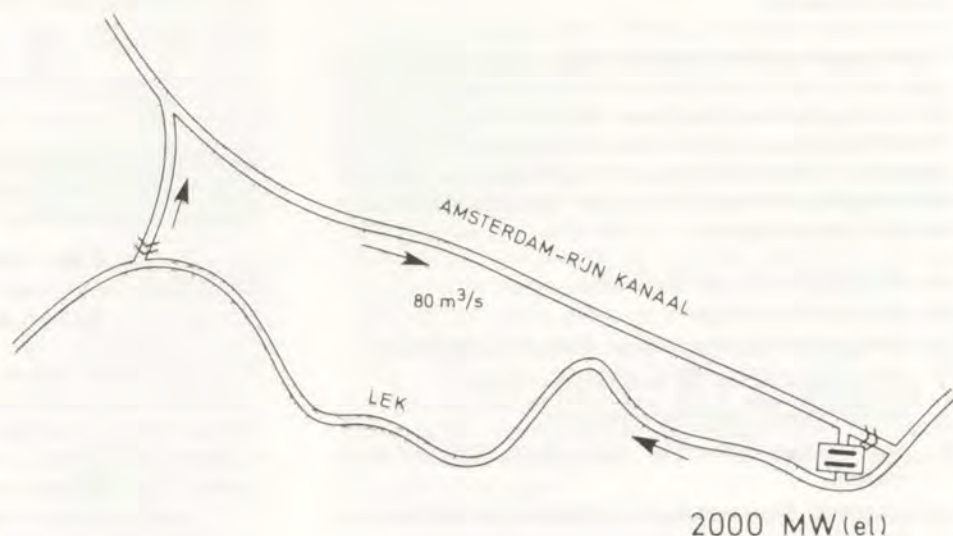
Afb. 13. Circuit voor een centrale van 2000 MW(el) te Wijk bij Duurstede met een circuitstroom van 80 m 3 /s en een lengte van 40 km.
