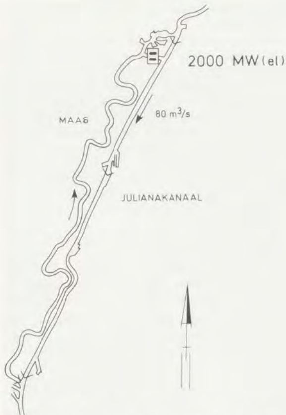
Afb. 12. Een opwaarts over het Julianakanaal en neerwaarts over de (grens) Maas lopend koelcircuit.
