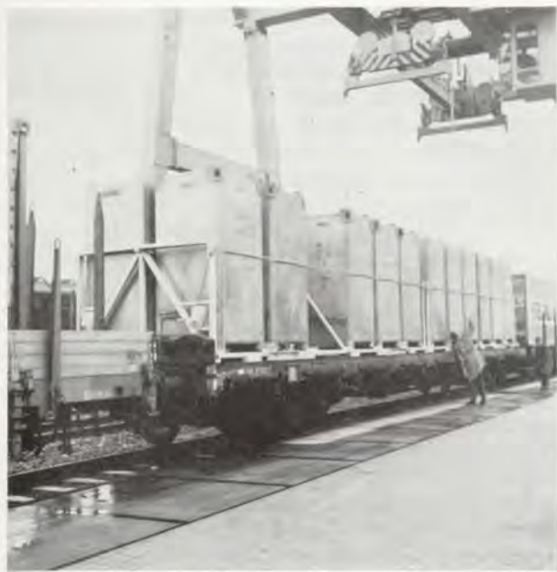
Afb. 11. Twee 30' flats op een spoorwagen. Voor ICI ontworpen door de N.V. Transportvoorlichting pendelen zij met nylonkorrels in laadkisten tussen Rotterdam en West-Duitsland. (foto Transportvoorlichting)
