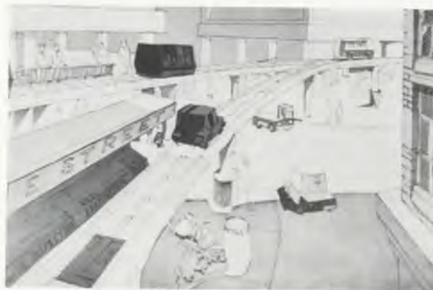
Afb. 14. Schets voor een dubbelsysteem: boven links station voor Individueel Openbaar Vervoer. Links onder: entree van viadukt door stadsauto. Dit laatste elimineert de overgangprocedure (ontleend aan Tomorrow's Transportation).
