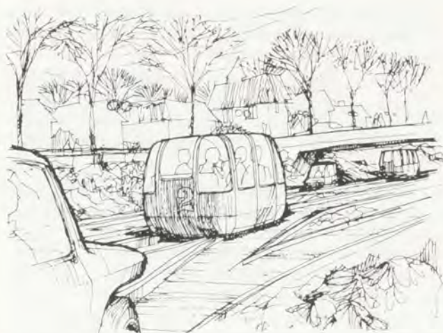
Afb. 13. Schets voor een dubbelsysteem. Wagen no. 2 behoort tot de vloot automatisch bestuurd voertuigen van het Individueel Openbaar Vervoernet. Links een openbare stadsauto, op het punt de vrije baan op te rijden (ontleend aan: Future Urban Transportation Planning).
