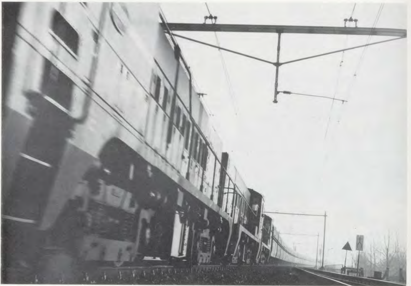
Afb. 5. Drie lokomotieven voor een ertstrein van Amsterdam naar het Ruhrgebied. De trein wordt door één machinist gereden. Er worden ook treinen met vier lokomotieven gereden; het treingewicht loopt dan tot 3000 ton op.
