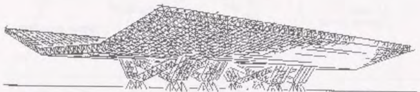
Fig. 9.12 Voorbeeld van een ruimtevakwerk Bron: [Siegel, 1960]
