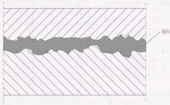
Fig. 5.11 Alle oneffenheden worden opgevuld door lijm, die daarna verhardt
